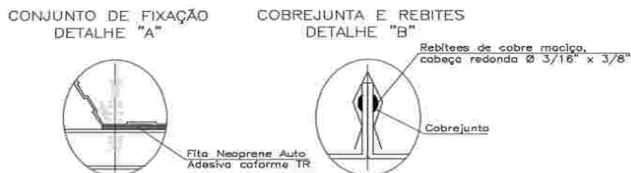
Figura nº 04 - Detalhes das fixações e arremates da telha autoportante
